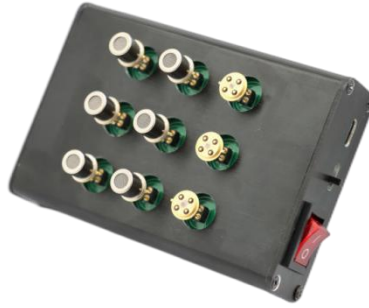
多功能气体传感阵列检测模块实物图
