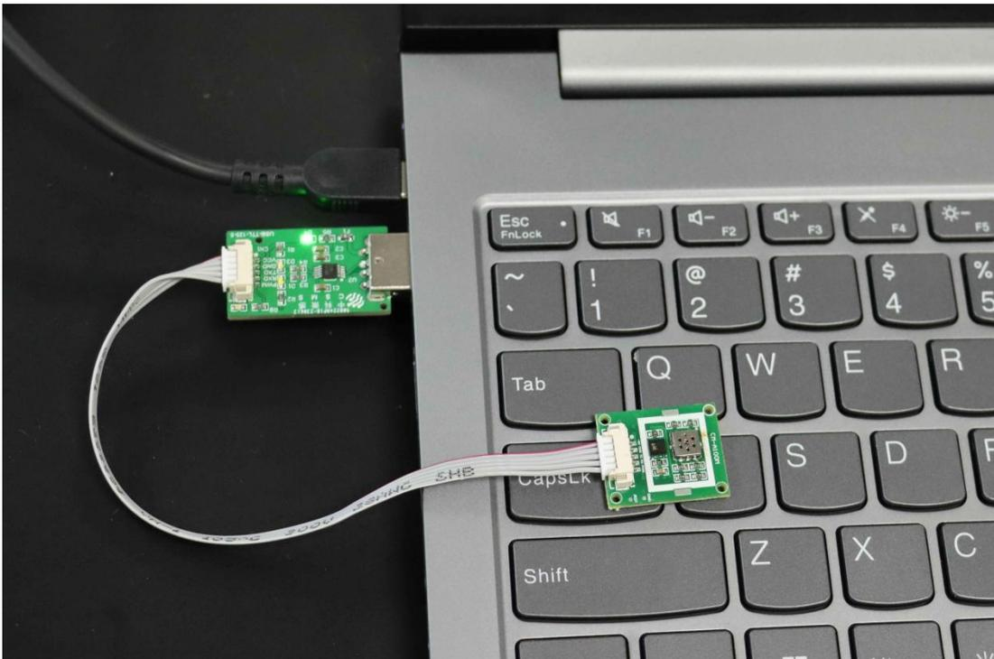
2. 单通道多功能气体传感阵列检测模块可定制电压，默认 1.5V。
