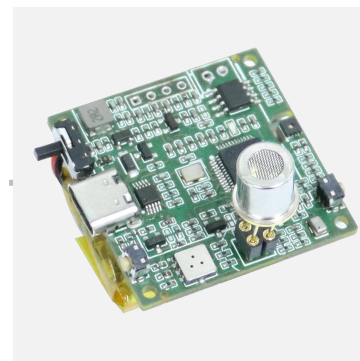
PCB 板设计 (LGA、陶瓷、TO5 封装传感器)
