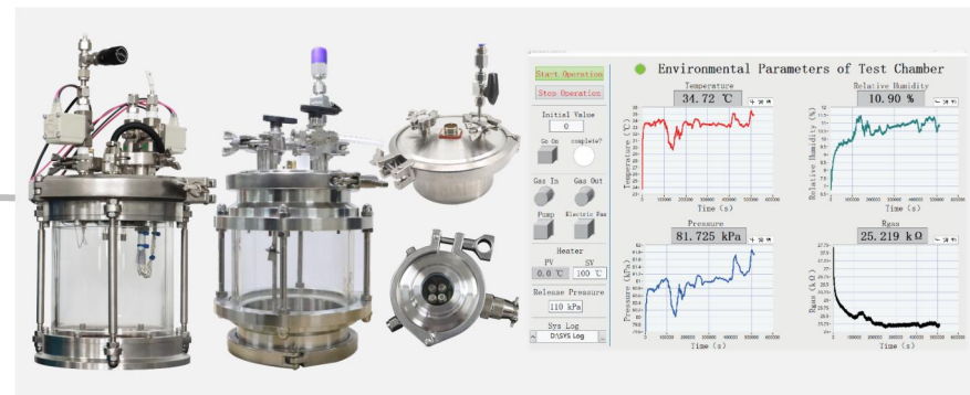
测试腔体及腔体气氛控制软件
